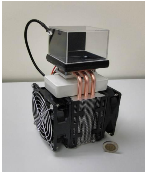
圖 1 使用帕爾貼冷卻器的雲室。
